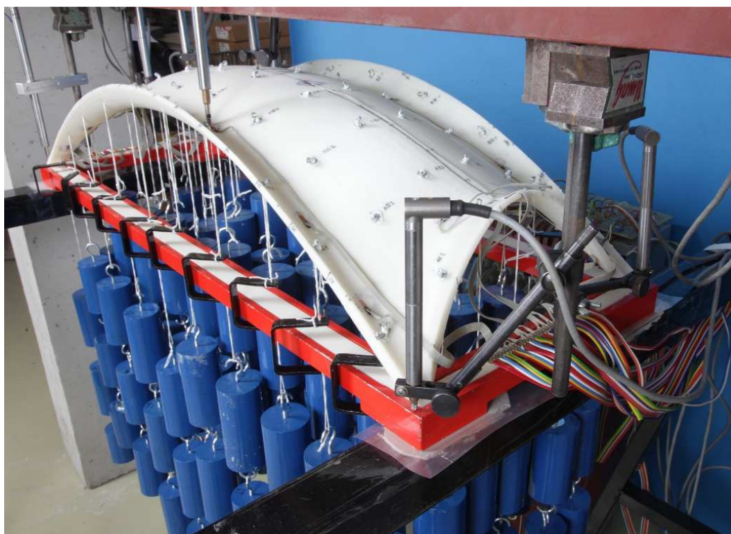
Obr. C-9 Uložení konstrukce na podporu
