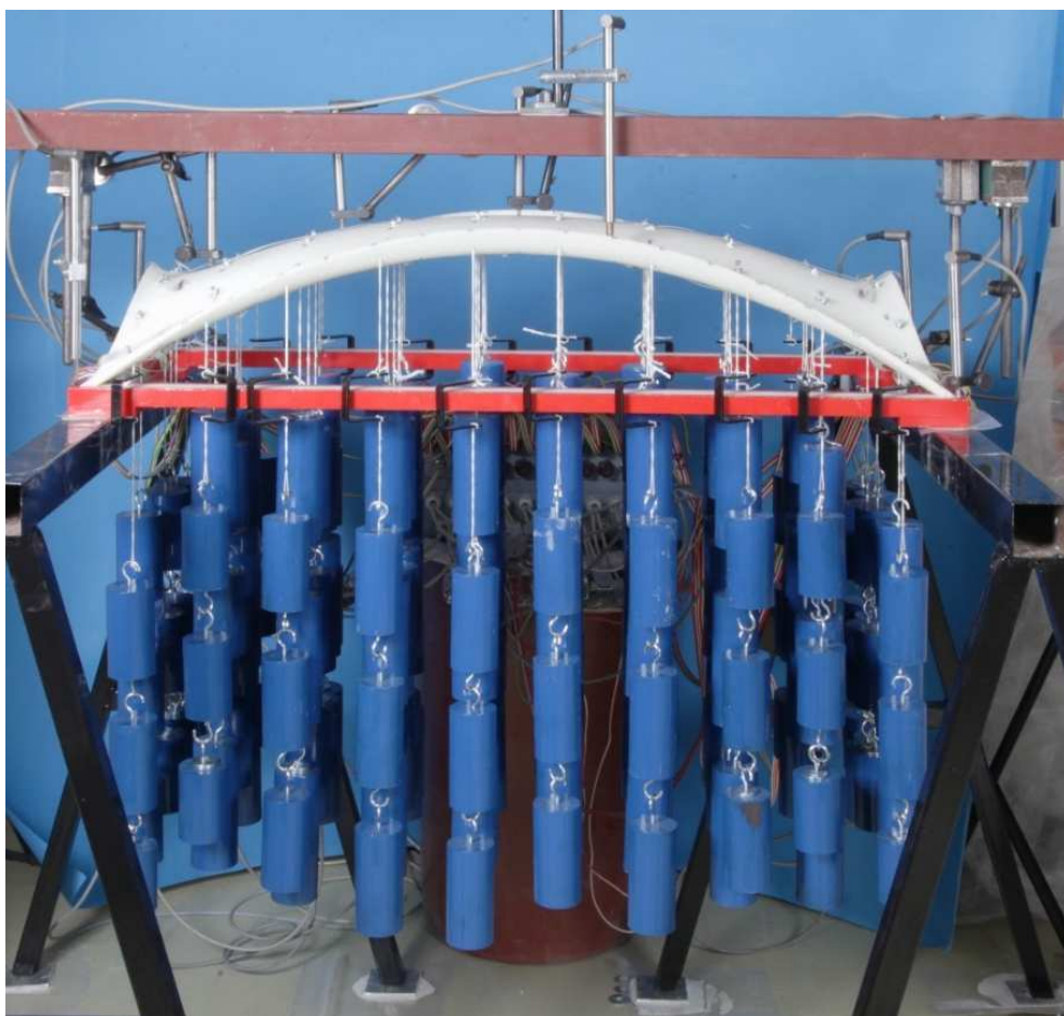
Obr. C-7 Skořepina při plném zatížení (SW+SN1)
