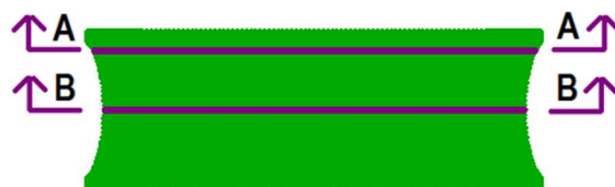
Obr. D-11 Vedení řezů pro vyhodnocení deformací, SW+SN1
