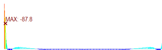
Obr. E-71 Ohybový moment M_z [kNm], SW+P+SN2
