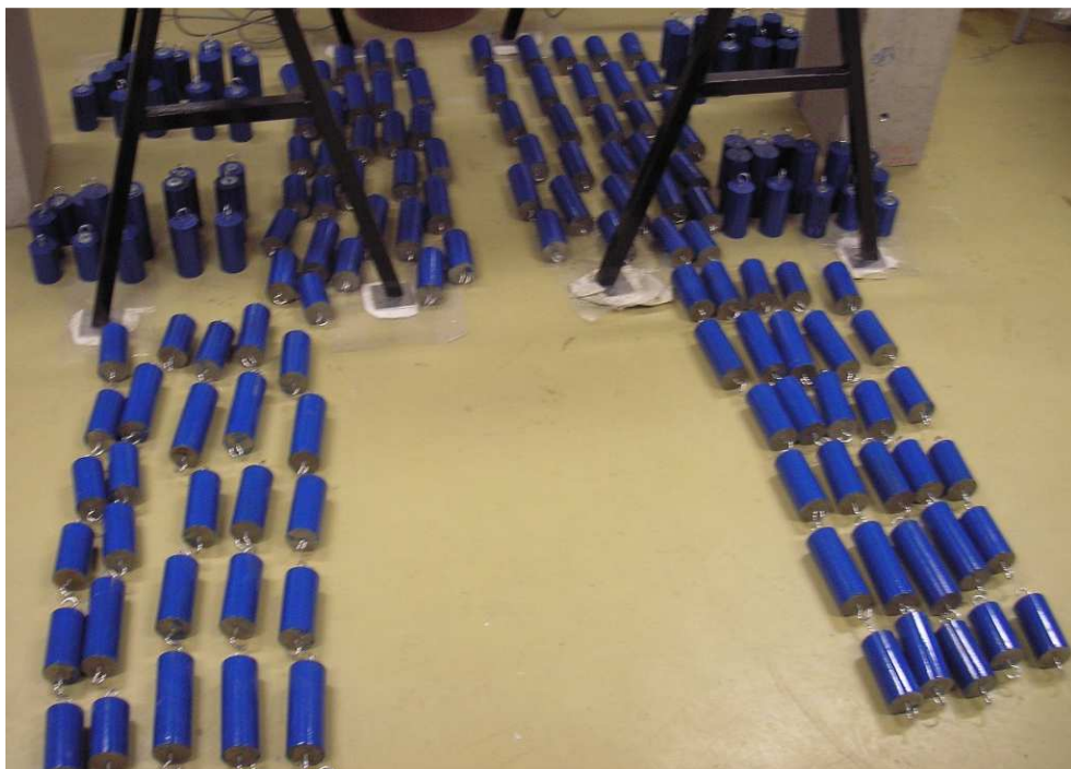
Obr. C-6 Závaží připravená na zavěšení na skořepinu
