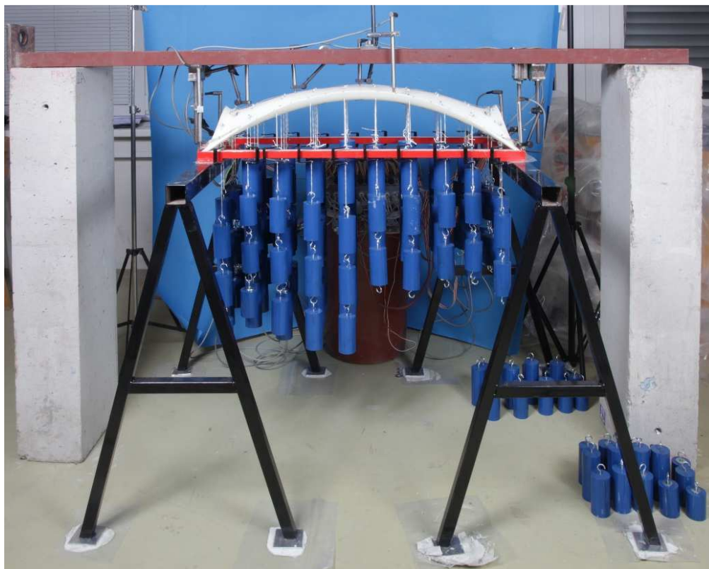
Obr. C-8 Uspořádání experimentu-ocelové podpory, nosník pro osazení měřičů deformaci, zatížení SW+SN2
